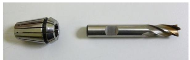
Die Spannmutter mit dem Fräskopf wird in einer Halterung an der Spindel befestigt. Diese Halterung ist für alle Spannmuttern geeignet.
