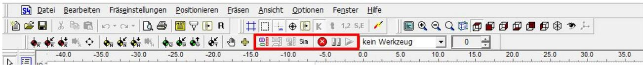
Zur Aktivierung des Simulationsmodus Button „Sim“ drücken.
