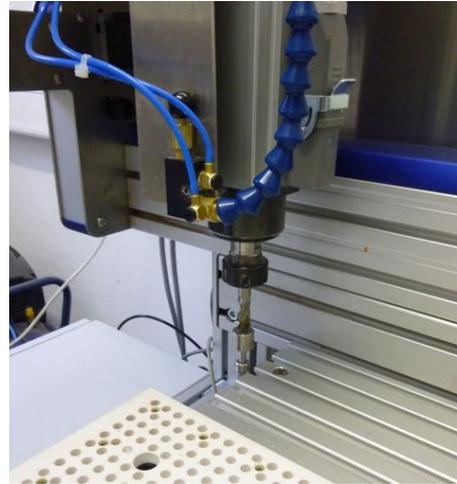
Der z-Nullpunkt muss vor jedem Fräsvorgang, bzw. nach dem Wechseln des Werkzeuges, neu eingestellt werden.
