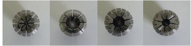
Die Fräser müssen in die zu ihnen passende Spannmutter eingesetzt werden. Teilweise haben die Fräser Markierungen bis zu welchem Punkt sie in die Spannmutter eingeschoben werden. Falls keine Markierung vorhanden ist, wird der Fräser mit dem oberen Teil des Schafts eingeführt.
