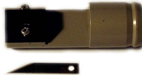
Mit dem Schraubenzieher werden nun die beiden Schrauben gelöst und die Klinge heraus genommen. Die Klinge muss so an die Kante gelegt werden, dass sich die Spitze des Messers in der Zylindermittte befindet.
