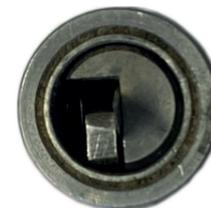
Nun wird die neue Klinge zwischen Metallklötzchen und Zylinder eingeführt, bis sich das Loch im Klingenschaft unter der Schraube befindet. Hierbei ist darauf zu achten, dass der Bolzen mit der Konkaven Seite in Richtung der Klinge zeigt. Die Schraube wird zunächst nur so leicht angezogen, dass sich die Klinge noch bewegen lässt.
