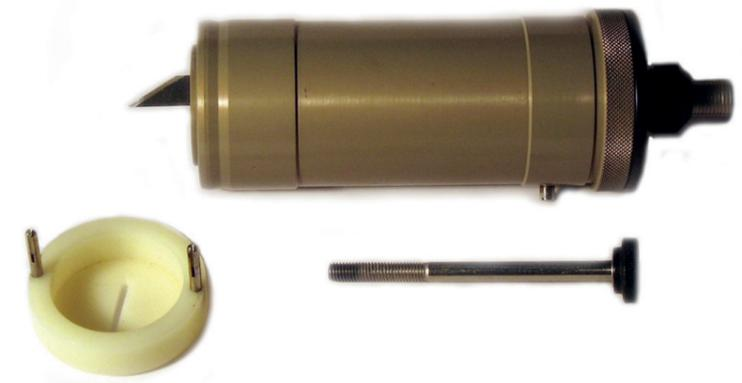
Anschließend muss die weiße Plastikabdeckung entfernt werden.
