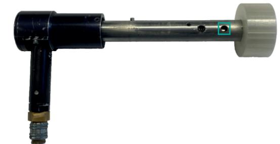
Vor dem Festziehen der Imbusschraube wird der Justierbolzen bis an den Anschlag auf den Metallschaft gesteckt. Nun kann die Schraube wieder mit dem Schlitzschraubenzieher festgezogen werden. Danach kann der äußere Zylinder wieder aufgeschoben und auch hier die Schrauben mit dem Imbusschlüssel wieder festgezogen werden. Danach wieder in den Plotter einsetzen, schwarzen Ring festziehen und Druckluft anschließen.
