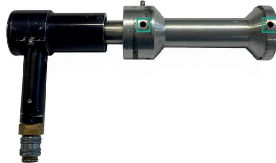
Zuerst werden die Schrauben des äußeren Zylinders mithilfe des Imbusschlüssels gelöst. Die Schrauben bleiben im Zylinder.
