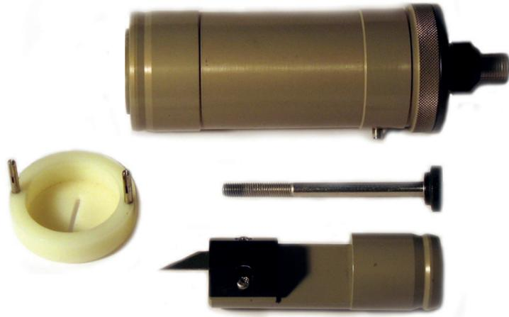
Jetzt kann der kleine Zylinder, in welchem die Klinge eingesetzt ist, vorsichtig mit der Hand aus dem großen Zylinder gezogen werden.
