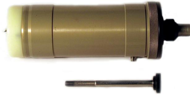
Zunächst wird die schwarze Schraube aus dem Zylinder gedreht.
